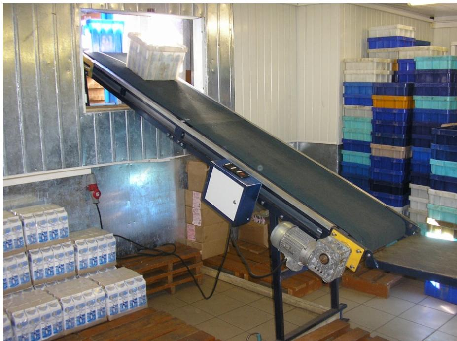
Конвейеры стационарные предназначены для перемещения различных грузов в горизонтальном или наклонном положениях. Конвейеры относят к высокопроизводительным транспортным системам. Разнообразие конструкций позволяет использовать конвейеры в различных отраслях. Конвейеры могут использоваться как внутри помещений, так и снаружи, на открытых площадках.
